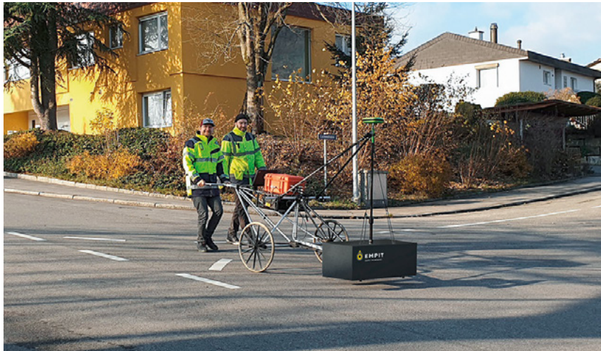
In Grenchen wurde das nichtinvasive Verfahren zur Detektion rohbruchgefährdeter Bereiche von Trinkwasserleitungen erfolgreich getestet.
